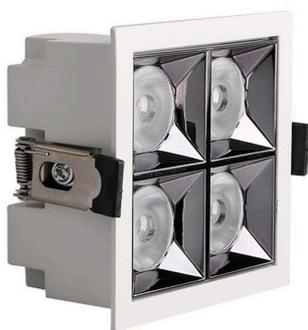
Foco empotrable LED con chip OSRAM SMD5050 de alta potencia y con 20W de potencia. Dispone de factor antideslumbramiento UGR 17 y un ángulo de apertura de 24°. Con una iluminación más directa para centrar la luz en puntos específicos. Una iluminación de acentuación elegante y distintiva.
