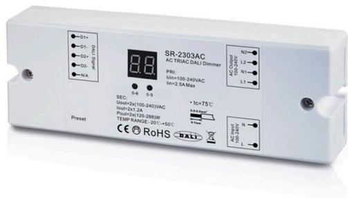
LED DRIVER de AC100-240V con control DALI. Controla el encendido/apagado (switch) e intensidad (TRIAC dimmable desde 3W a 576W) de luminarias led y driver led. Dispone de dos canales DALI con salida de 1,2A - AC220V cada uno que pueden ser programados de forma independiente con el master DALI.
