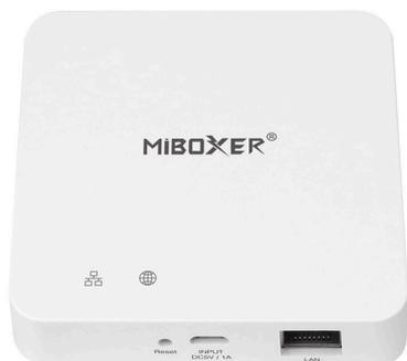
La puerta de enlace local Zigbee para tus dispositivos Zigbee proporciona conectividad Ethernet + Zigbee Mesh de alta velocidad, mayores posibilidades de automatización, memoria local para parámetros y dispositivos.
