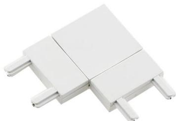
Conector Tipo L para Carril Magnético 20mm Super Slim 48V Superficie para conectar uno o más carriles magnéticos monofásicos 20mm Super Slim 48V de superficie. Este conector incorpora un conductor a cada lado de cobre que darán conexión al circuito eléctrico entre los diferentes tramos de carril magnético.
