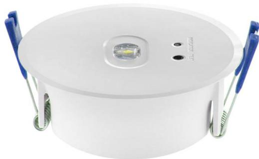
Luminaria LED de emergencia con función AUTO-TEST de alta calidad con diseño minimalista. Para instalación empotrado, de pequeño tamaño. Más de 180 minutos de autonomía con su batería recargable de Ni-Cd. Luz para señalización de salidas, puertas, ascensores, zonas de paso o comunes.
